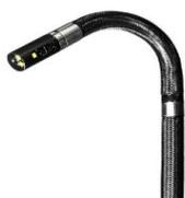
2つのカメラを搭載しており直視方向、側視方向の観察が可能。奥まった箇所（少し離れたところ）を観察する場合、ミラー方式よりも、クリアに見えます。
